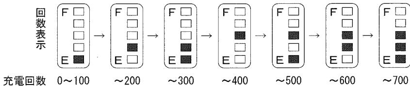
注：最上段ランプが点灯した場合はバッテリパックの経済寿命ですので、新しいバッテリパックをお買い求めください。
