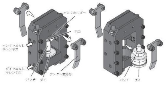
「150AT-DCM」ヘッドフレームにパンチカセットを取付けます。パンチカセット およびヘッドフレーム挿入面のゴミを十分に取り除いた後、パンチカセットをヘッドフレー ムの内側に密着するまで挿入し、ロックノブを確実に手で締め付けてください。カッタカセ ットが取り付けてある場合は、パンチカセット、カッタカセットの交換(P4)のとおりに交 換します。
