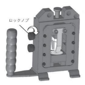
パンチカセット、カッタカセットの挿入およびロックノブの締め付けが不充分ですと、 パンチカセット、カッタカセットおよび工具が破損する恐れがありますのでご注意ください。
