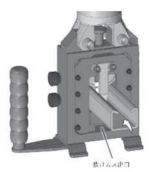
8. 工具本体のリリーススイッチを押してピストンを下死点まで下げます。抜けたカスが下方より出てきますので取り除いてください。
