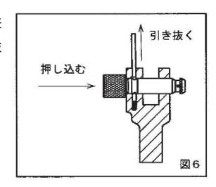
4)スライドピンを完全に差し込み、何度か抜き差しの動作をおこない、スライドピンの抜けや、ガタツキ等の異常がなければ取り付け完了です。
