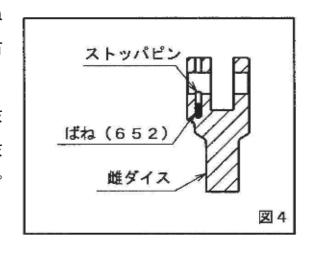
2)工具の雌ダイス上部の穴より直径2mmの 棒を入れ、ストッパピンを押し込んだ状態で グリスを塗布したスライドピンを挿入してく ださい。(図5)
