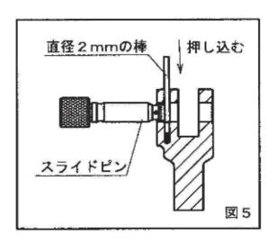
3) 手順2) の状態から、さらにスライドピンを差し込むと同時に、直径2mmの棒を引き抜いてください。(図5)
