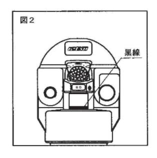
注:圧着が進むに従い、強い操作力(最大245N)が必要となりますので、 ハンドルは大きく開かず小きざみに開閉操作しますと楽な作業ができま す。
