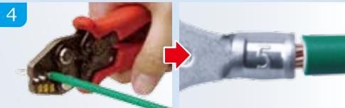
4. 成形確認機構が解除されハンドルが自力で開くまで荷重を加えます。ハンドルを開き、圧着した端子またはスリーブを取り出し正しく圧着されていることを確認します。
