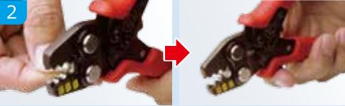
2. 端子またはスリーブを呼び寸法に合ったダイス部に端子の接合部を上に向けてセットした後、軽く握り、端子またはスリーブが落ちない程度に保持します。
