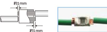
端子は両方とも電線の心線部が約1mm出た状態で圧着する
