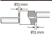
端子は両方もとも電線の心線部が約1mm出た状態で圧着する
