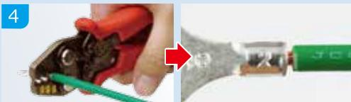
4. 成形確認機構が解除されハンドルが自力で開くまで荷重を加えます。ハンドルを開き、圧着した端子またはスリーブを取り出します。
