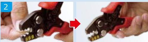
2. 端子またはスリーブを呼び寸法に合ったダイス部に端子の接合部を上に向けてセットした後、軽く握り、端子またはスリーブが落ちない程度に保持します。
