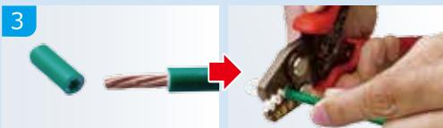
3. 電線の被覆を所定の長さに剥き、端子またはスリーブに挿入します。
