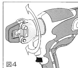
**!** 注:スライドピンの差し込みが不十分のまま圧着作業をおこないますと工具が破損する場合があります。
