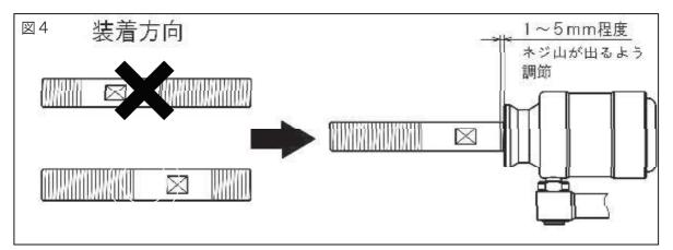
▲ 注意 強くねじ込むと、セットボルトが工具本体から外れなくなる恐れがあります。
