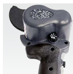
電線サイズに合わせてオートリバースを調整
